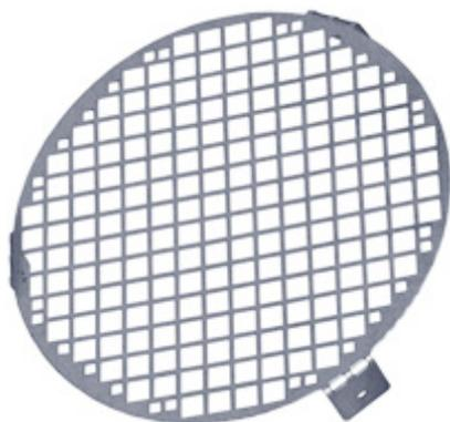
Защитная решётка БСК предназначены для защиты круглых каналных вентиляторов и других элементов вентиляционных систем от попадания в них посторонних предметов Коэффициент живого сечения решеток равен 0,63. К патрубкам вентиляторов и воздуховодам решетка крепится саморезами.
