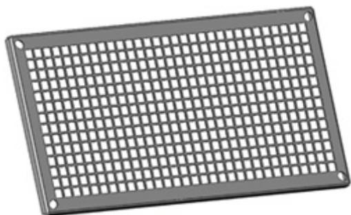
Защитные решетки БСР предназначены для защиты прямоугольных канальных вентиляторов и других элементов вентиляционных систем от попадания в них посторонних предметов. Коэффициент живого сечения решеток равен 0,72. К фланцам вентиляторов и воздуховодов решетка крепится болтами.
