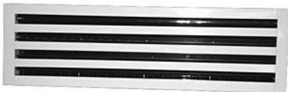
Приточные щелевые решетки APC, АЛС предназначены для подачи воздуха в помещения различного назначения системами вентиляции и кондиционирования, в том числе с переменным расходом воздуха. Решетки APC обеспечивают устойчивость струи приточного воздуха в диапазоне изменения объемных расходов от 100% до 25% в том числе в режиме охлаждения. Вытяжные решетки АВС предназначены для удаления воздуха из помещений.
